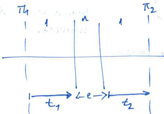
$$M = \begin{pmatrix} 1 & -t_2 \\ 0 & 1 \end{pmatrix} \begin{pmatrix} 1 & -\frac{e}{n} \\ 0 & 1 \end{pmatrix} \begin{pmatrix} 1 & -t_1 \\ 0 & 1 \end{pmatrix} = \begin{pmatrix} 1 & -(t_1+t_2+\frac{e}{n}) \\ 0 & 1 \end{pmatrix}$$
